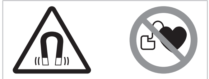
Fig. 9: Panneaux d'avertissement et d'interdiction sur un compresseur avec moteur à aimant permanent
